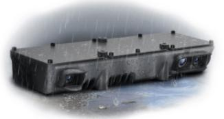
Carnegie Robotics 社の MultiSense S27 は非常に優れた耐振動・衝撃性能と防水防塵性能を持つ屋外用途向けステレオ 3D センサです。測距レンジ 1.4m ~ 30m、使用環境温度 -40°C ~ +80°C、耐振動・衝撃性能：15G/100G と防水防塵性能 IP67 の高い環境性能を持っています。カメラアングルが水平（ボディ面）より下向き 24°になっており周辺のセンシングなどに使いやすくなっています。
