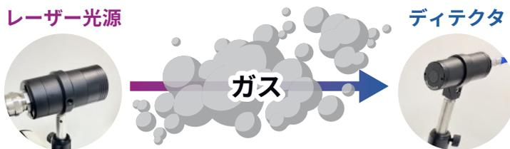
光源から照射されたレーザーはガス中を通りディテクタで強度を計測されます。
